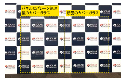
■ パネルセパレータ処理後と新品のカバーガラス対比（処理後のカバーガラスは、新品同様の透明度）
