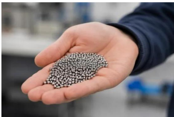
発電機のエネルギー源となるアルミニウムペレット
