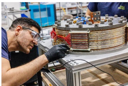
ステラレーター装置に用いる 平面電磁コイル
