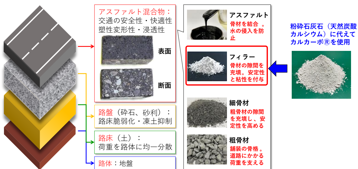
アスファルト舗装への「カルカーボ®」の使用イメージ
