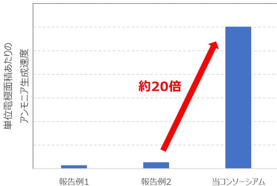
図1. 常温・常圧下、窒素・水・電気を用いたアンモニア電解合成反応の性能値比較
