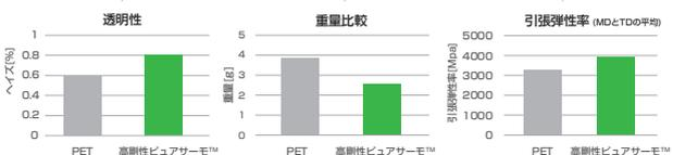
※厚み0.25mm、幅160mm、長さ72mmの成形品を測定。
