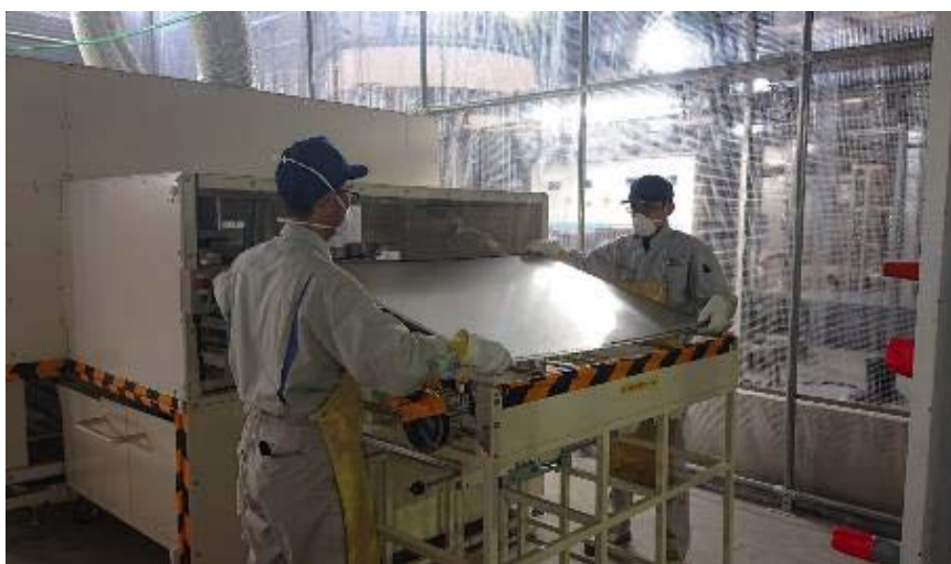
(パネルセパレータ処理後の CIS 薄膜太陽電池モジュール)
