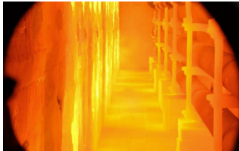
2024 年 2 月に完成したアンモニア中間貯蔵設備 アンモニア燃焼時のナフサ分解炉の様子
